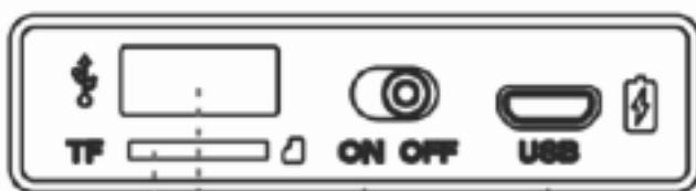
Tarjeta micro SD -> Puerto USB -> Botón "ON / OFF" -> Puerto de carga micro USB
